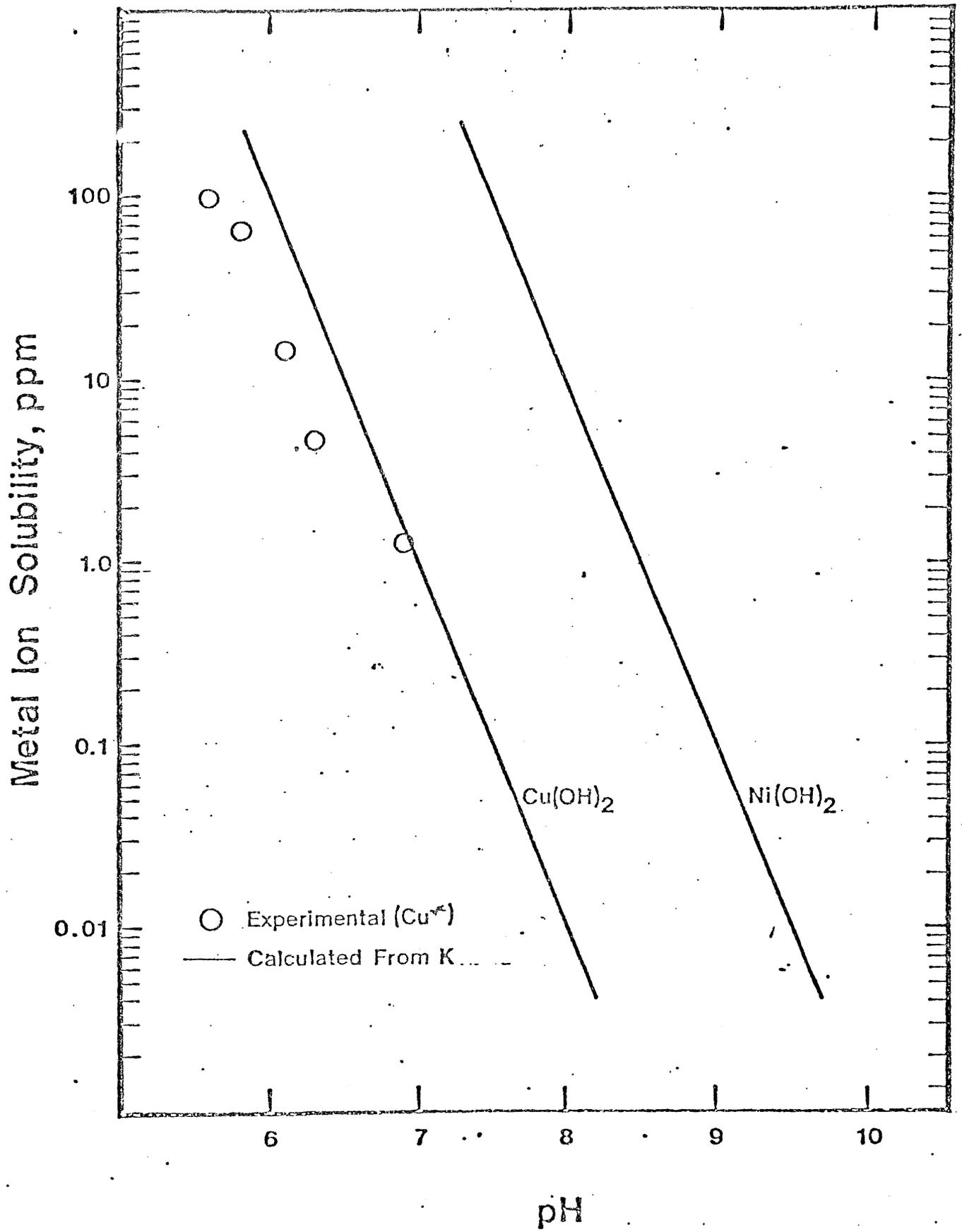
FIGURE 15. COPPER AND NICKEL ION SOLUBILITY AS A FUNCTION OF pH<sup>7</sup>
