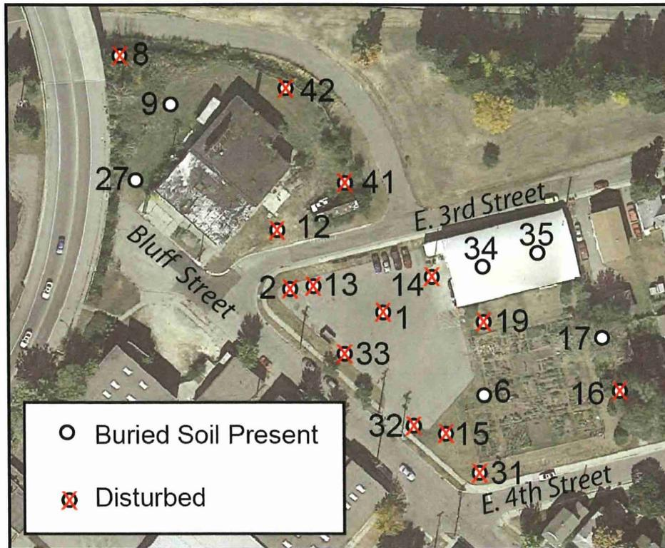
FIGURE 46. RESULTS OF ENVIRONMENTAL SOIL BORINGS WITHIN THE GAS WORKS AND LIGHT INDUSTRIAL LOCALITIES
